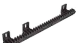
Crémaillère M4, 25x20x1000 fendue, en nylon, avec âme en acier, fournie avec les vis (10 mètres/conditionnement)
